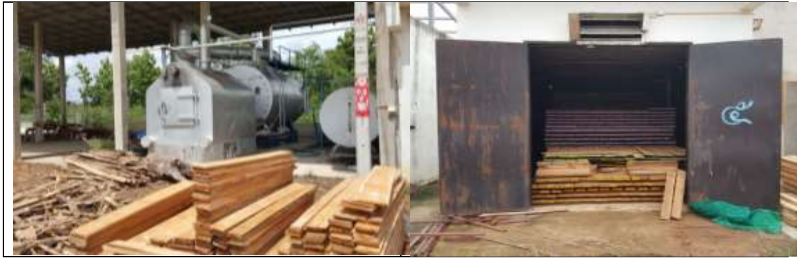
รูปที่ 6 การรีดความชื้นของไม้สัก แบบอบความร้อนด้วยระบบสุญญากาศ
