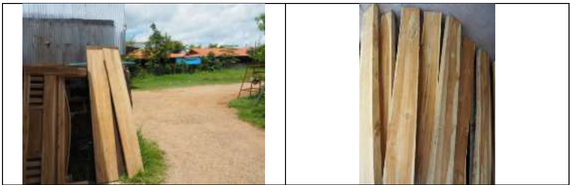
รูปที่ 7 การรีดความชื้นของไม้สักด้วยวิธี แบบแอร์ดราย (Air Dry)
